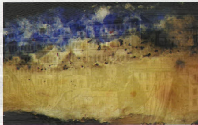
5 - SEZIONE STATIGRAFICA DEL "PORTAIL PEINT" NELLA CATTEDRALE DI LOSANNA Lapislazzuli su uno strato di biacca e nero di carbone, ricoprente la preparazione bianca.
