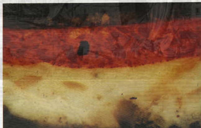
4 - SEZIONE STATIGRAFICA DEL "PORTAIL PEINT" NELLA CATTEDRALE DI LOSANNA Cinabro sulla preparazione bianca a base di biacca, ricoperto dalle scialbature grigie.
