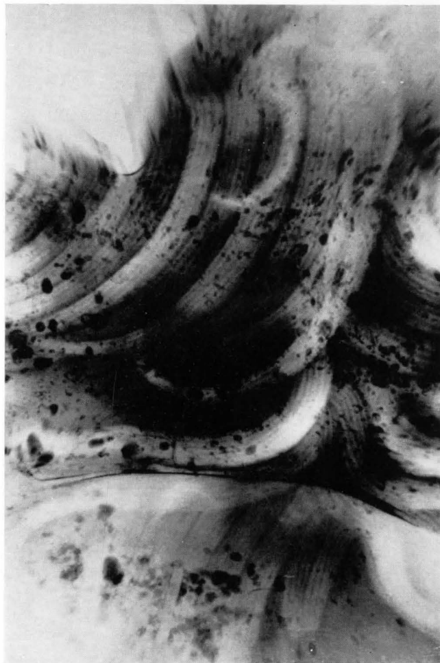
7 - RADIOGRAFIA DELLA CALOTTA CRANICA DEL "FILOSOFO" Si notino le soffiature diffuse presenti nelle ciocche e la linea di saldatura. In basso sono visibili due tasselli di riparazione.
