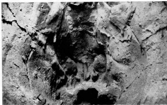
4 - INTERNO DELLA TESTA CARAFA, ZONA DEL MUSO SUL FONDO, I CANALI DI COLATA INTERNI TRANCIATI. Si notino la fessura circolare di giuntura e in alto le "pezze" colate a cera persa.
